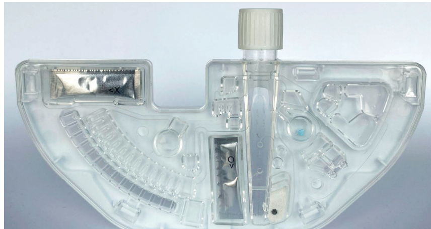
Abb. 2. Detektionsmodul für den PCR-basierten Nachweis von Zielgenen. Alle Reagenzien sind im geschlossenen System bereits enthalten.
