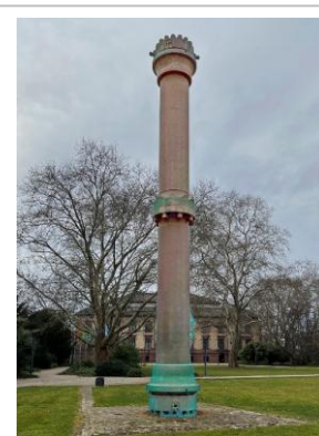
Druckreaktor für die Ammoniak-Synthese (Foto: Franz Schütz)
