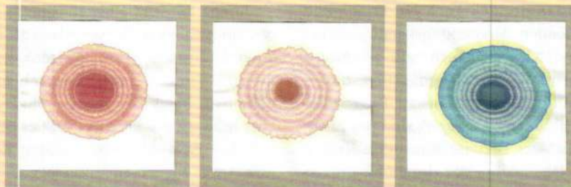
Abb. Info 2-1 Drei gemäß der Beschreibung hergestellte chemische Bilder nach F. F. Runge, v.l.n.r.: a) Kupfer(II)-hexacyanidoferrat(II) (zuerst \text{CuSO}_4 -Lösung 1, dann \text{K}_4[\text{Fe}(\text{CN})_6] -Lösung 2), b) Kupfer(II)-hexacyanidoferrat(II) (zuerst \text{K}_4[\text{Fe}(\text{CN})_6] -Lösung 2, dann \text{CuSO}_4 -Lösung 1) und c) Berliner Blau (zuerst \text{FeSO}_4 -Lösung 3, dann \text{K}_4[\text{Fe}(\text{CN})_6] -Lösung 2) (Quelle: Alexander Kraft).
